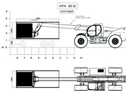
Gracias a este patentado sistema, El porta horquillas hace posible tomar y transportar las cargas desde dentro del contenedor y, con un simple comando en la cabina, las horquillas pueden ser hidraulicamente ajustadas al ancho del contenedor.
